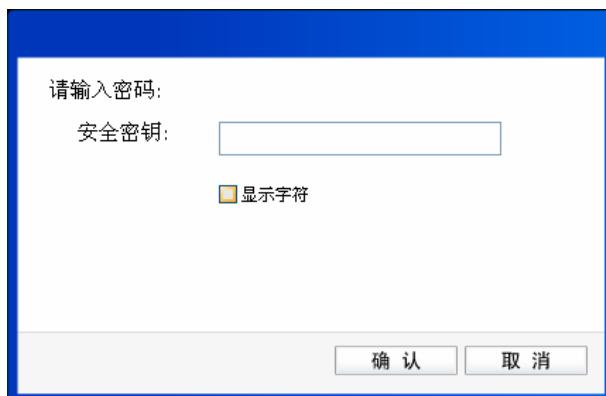
若提供该网络的无线路由器或 AP 还支持 QSS 或 WPS 快速安全设置功能，系统界面将如下图所示，此时无需输入密码，直接按下无线路由器或 AP 上的快速安全设置按钮即可。
