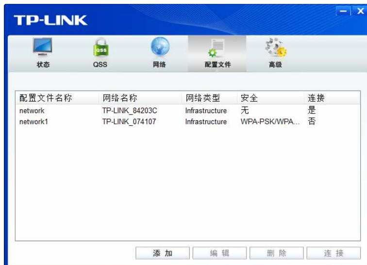
配置文件添加已完成，您可以点击**连接**按钮将网卡连入此无线网络。
